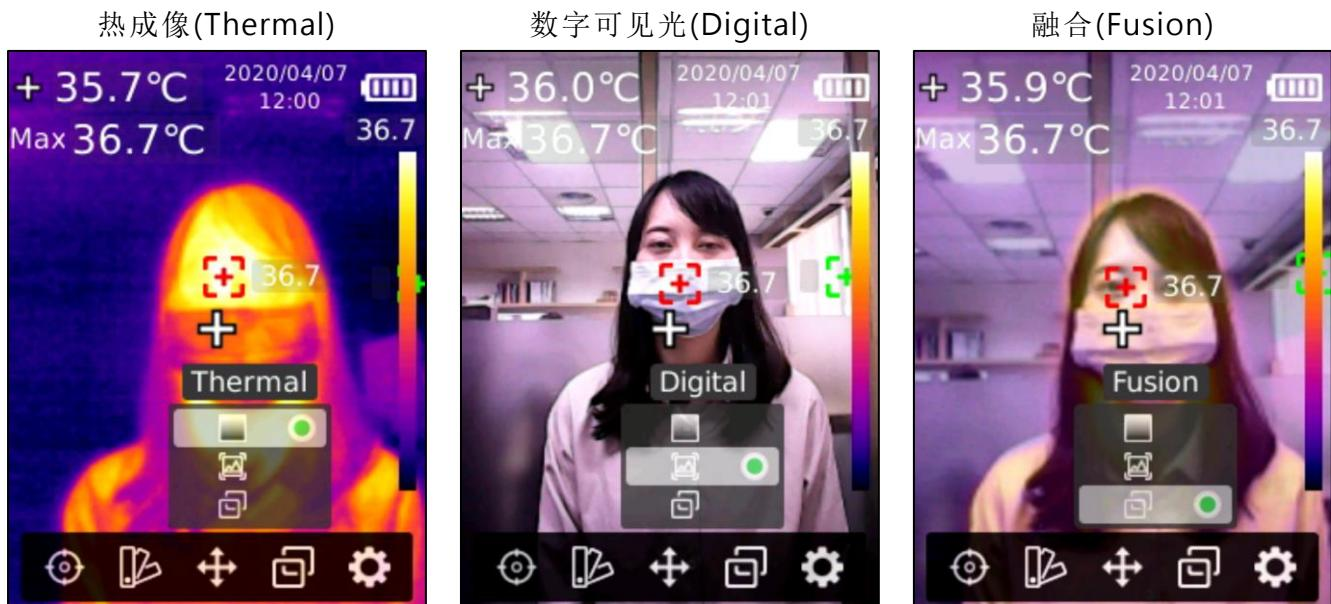
在融合成像模式下，返回热成像测量画面后，可以通过按左/右按键选择不同融合比例，融合比例有0%（全可见光）、25%、50%、75%、100%（全热成像）。
